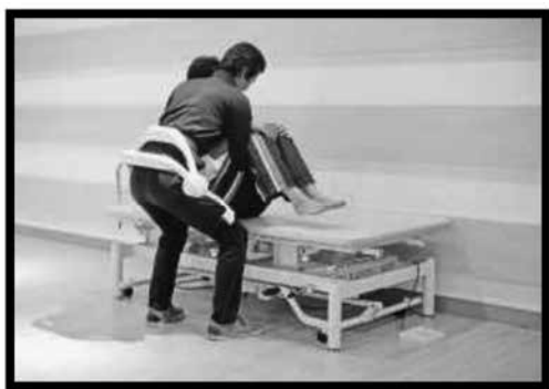
図1. 移乗支援・装着型パワーアシスト
